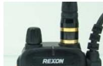
Bei aufgeschraubtem HF-Adapter kann es zu einer leichten Dämpfung des Antennesignals (max 1,5db) kommen.
